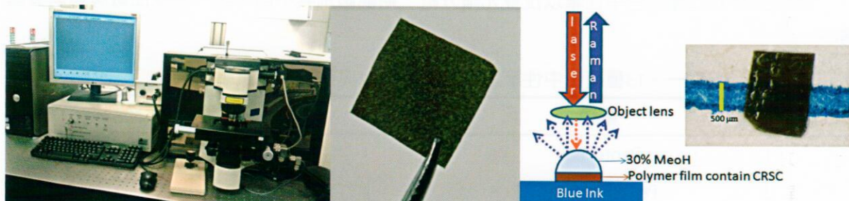
圖五、Jobin-Yvon LabRam HR 800 Raman microscope (左)、聚合薄膜外觀(中)與使用聚合薄膜之SERS技術示意圖(右)。
