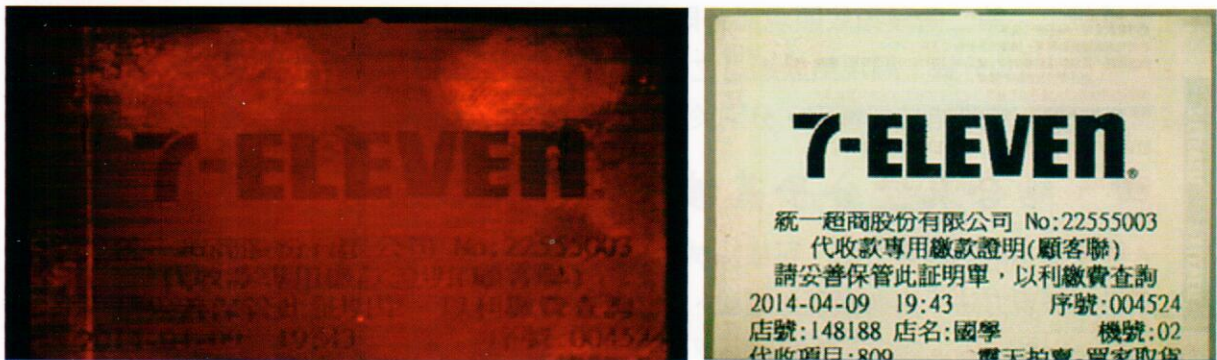
圖四、真空蒸鍍1,2-Indanedione藥劑顯現熱感紙上潛伏指紋顯現情形。 (a)螢光指紋顯現情形、(b)樣品上字跡保持完整。
