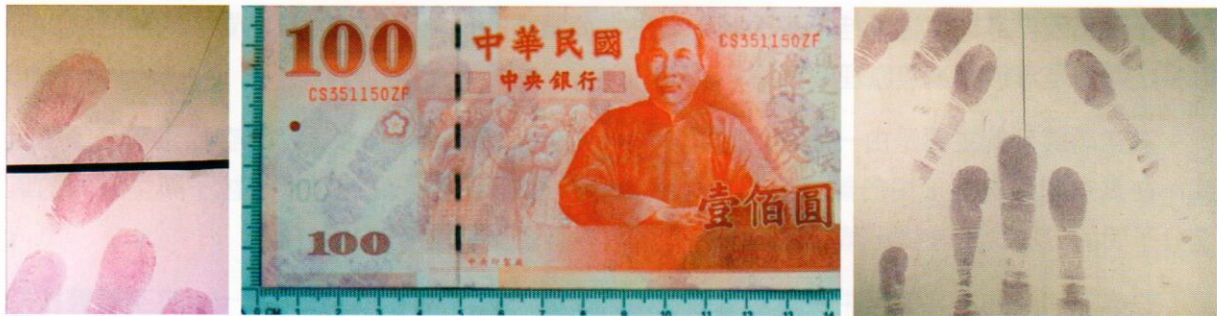
圖三、真空蒸鍍寧海德林藥劑顯現紙張上潛伏指紋顯現情形。(a)熱感紙、(b)鈔票與(c)影印紙
