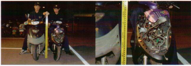
照片1-4：9909-1號重機車左側飾條夾縫處燈殼碎片及9908-1號重機車右前方向燈位置相對高度比對情形
