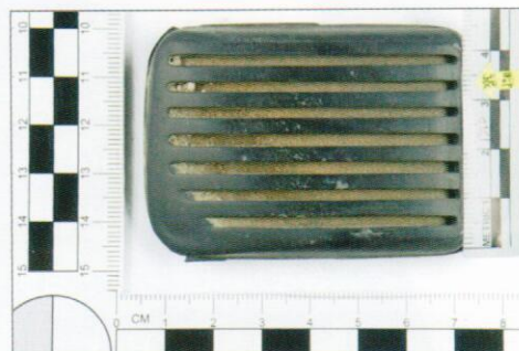
照片七、駕駛座的煞車踏板上包覆橡膠之直條紋
