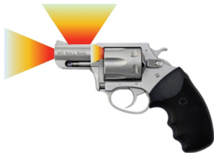
圖12、未燃燒完全的火藥顆粒可由槍口、轉輪連接槍管間隙及槍管上方噴射而出之示意圖
