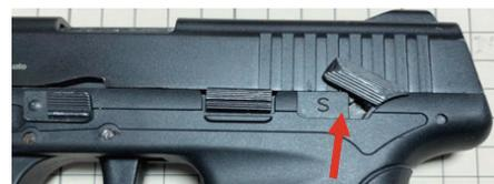
圖二十五、編號04半自動手槍型信號槍滑套左側後端的手動保險標示
