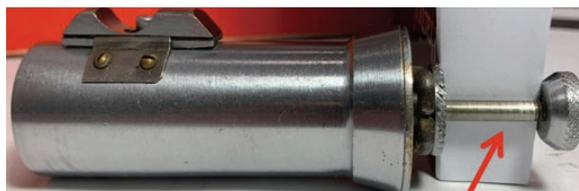
圖十七、編號03鋼筆型信號槍槍機拉柄向後拉到底之待擊發狀態
