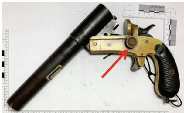
圖十、編號02手槍型信號槍槍管折開之開門狀態，箭頭指向開門按鈕。
