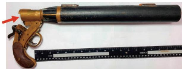
圖六、編號01改造信號槍自上方折開，露出彈室之開門狀態
