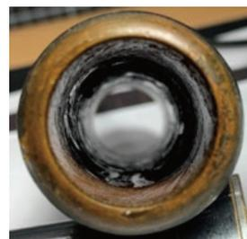
圖十八、編號03鋼筆型信號槍槍管貫通，為無來復線之滑膛槍管
