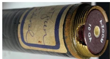
圖十九、編號03鋼筆型信號槍彈室可裝填10 GA口徑之散彈啞彈
