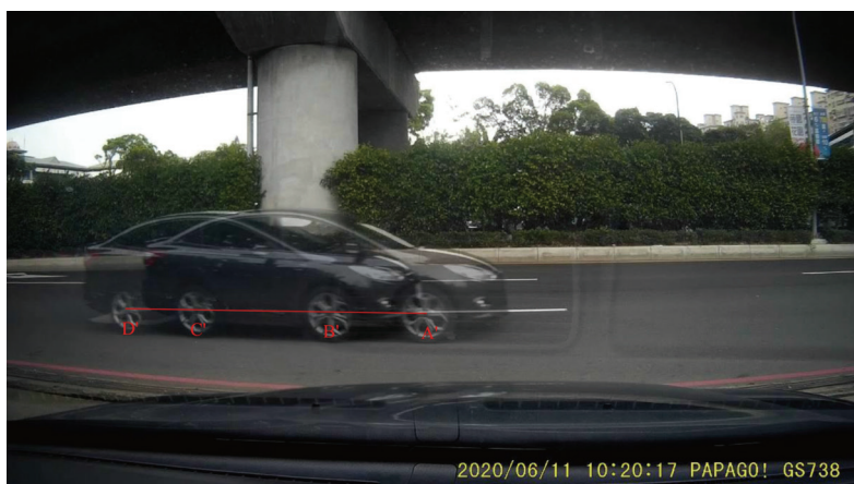
圖4、運用交叉比值分析估算車速之示意圖 (4)
