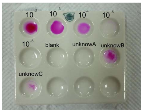
圖一 血液經十倍系列稀釋後進行酚酞試劑之靈敏度分析。顯示血液經十萬倍稀釋仍具有微弱的陽性反應，而未知檢體 unknowB 及 C 經初步試驗為陽性反應
