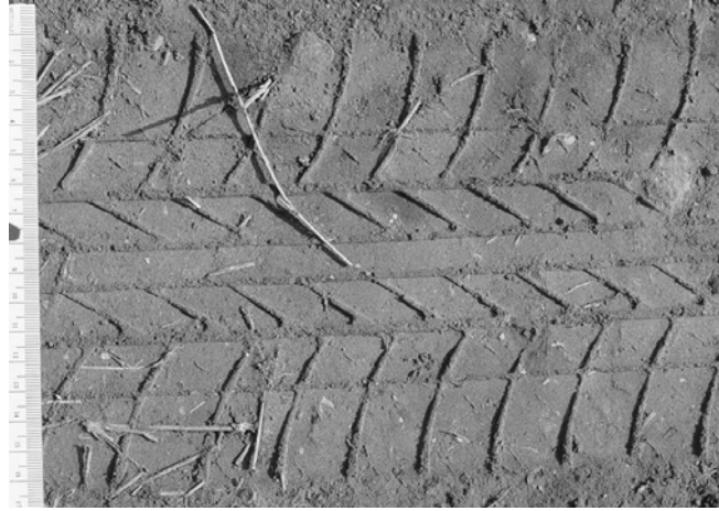
圖 2 輪胎印痕的胎紋型態有助於研判輪胎型式和製造商
