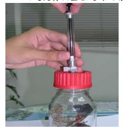
會造成許多含水雜質摻附在證物上,檢 體通常必先進行前處理回收步驟,回收 物再進行氣相層析法儀器分析。常見幾 種縱火劑回收的前處理方式包括:(1) 直接頂空法(direct headspace),將容器
