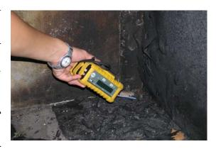
上述現場勘察方法研判起火點;對點火方法的鑑識方面需檢視電線、 打火機、火柴、蠟燭等殘跡特徵、縱火劑特殊燃燒型態(burning patterns)及其殘跡;對研判是否為人為縱火部分則需採取建築物被破壞之特徵、縱火劑殘跡、多處起火點特徵等。為偵檢現場是否遺留 液態縱火劑殘跡的蹤影,火場中可利用各項特徵資料或輔助工具,進行債檢縱火劑可能之殘留位置,俾利迅速準確地加以採樣,以保存珍貴之物證。使用的方法包括(1)物理特徵辨識法(physical indicator examination)、(2) 嗅覺分辨法(application of one's sense of smell)、(3) 攜帶式氣體偵測法(hydrocarbon gas detection)、(4) 警犬之應用(application of arson dog)、(5) 攜帶式氣相層析法(portable gas chromatography)、(6) 化學染色法(chemical color test)。
