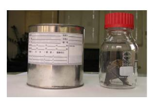
現場擬採樣的標的,應以多 孔性具吸附能力的檢體為主,如 混凝土地板、木質地板、舊布、 室內裝潢或地毯等,採取之材質應包括炭化、位炭化與中間部位,並盡量於三日內完成。現場除採取可疑標的位置檢體外,仍須採取非標的位置而在附近且與標的檢體相同材質之比對檢體。一般易燃性縱火劑多為高揮發性有機物,必須使用適當的容器加以包裝保存,俾供實驗室分析鑑識,如使用不當之容器將導致縱火劑漏失或污染,常用的容器有:聚酯類塑膠袋、耐龍類塑膠袋、乾淨鐵罐、玻璃罐等。
